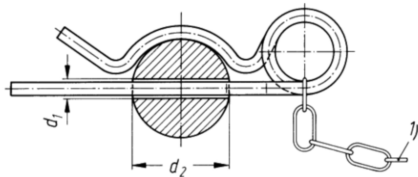
Pour le diamètre de percage des trous  $d_1$  (nom.), il est conseillé de respecter la tolérance H13.
